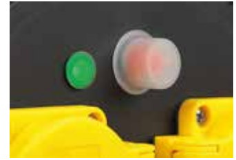
Zusätzliche Sicherheit durch Thermo-schutzschalter und Betriebsanzeige (modellabhängig)
