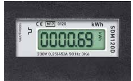
Ein MID-konformer 3 Energieverbrauchsähler zählt zur Serienausstattung des Qube+.
