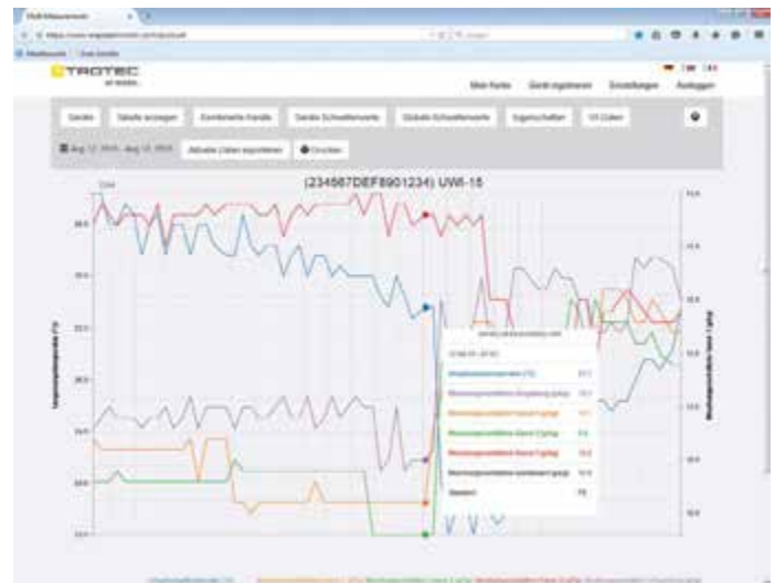
In der Detailanzeige wird der Trocknungsverlauf für die gewählte Zeitperiode abgebildet. Eine alternative Tabellendarstellung der Messwerte ist ebenfalls problemlos möglich.
