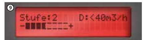
Das Optiflow-NT-Multifunktionsdisplay zeigt Ihnen farbgestützt die Aufbaueffizienz Ihrer Trocknungsinstallation an.
