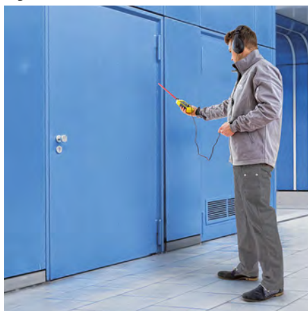
W połączeniu z nadajnikiem ultradźwiękowym SL800T, wykonanie kontroli szczelności takich elementów jak drzwi ogniodoporne jest szybkie i tanie.
