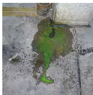
Uranin Green jest widoczny gołym okiem w miejscu wycieku a fluorescencja w świetle UV umożliwi wykrywanie techniką Tracer także dużych powierzchni.
