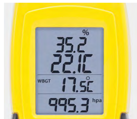
Podświetlany wyświetlacz LCD modelu TC100 wskazuje jednocześnie cztery wartości pomiarowe. Są one czytelne także przy złym oświetleniu otoczenia.
