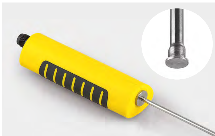
Na końcu czujnika pomiarowego o długości 150 mm (ø 3,5 mm) znajduje się wykonany ze srebra element kontaktowy (ø 6 mm), służący do pomiaru temperatury.
