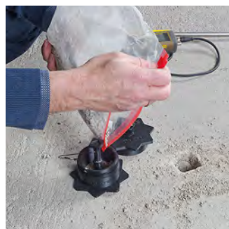
Krok 3: Napełnianie komory pomiarowej materiałem próbki
