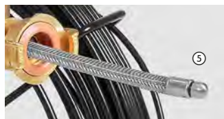
Wersja kabla 50 metrów modelu LD6000PTS jest wyposażona w głowicę czujnika z gumowym kołnierzem i kulą prowadzącą. Wersje o długości 80, 100 i 150 metrów posiadają głowicę w oplocie stalowym.
