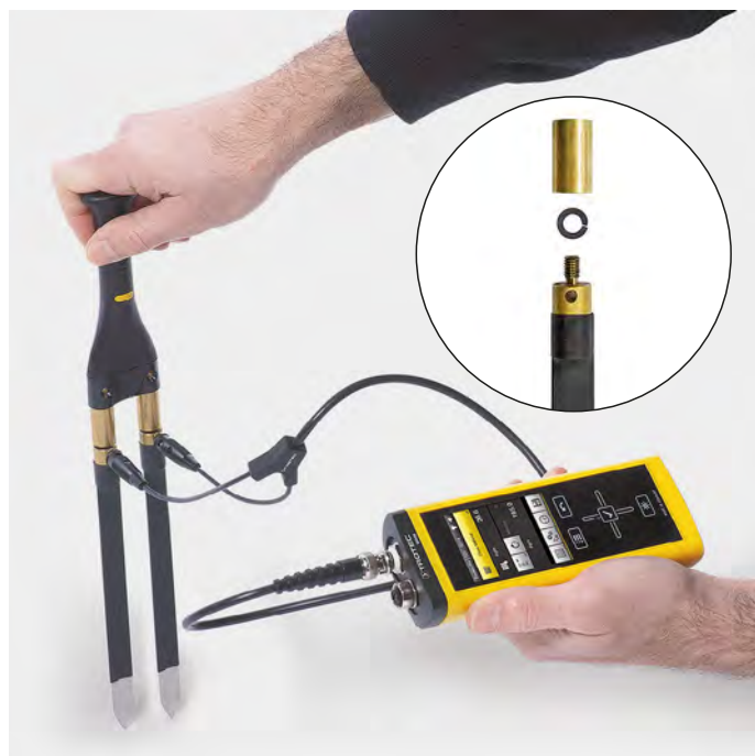
Zestaw adapterów TS 60 (19) pozwala na bezpośrednie dołączenie wszystkich elektrod MultiMeasure do elektrody ręcznej TS 60 (9). Obie strony adapterów posiadają gwint i są przykręcane pomiędzy głowicą elektrody oraz kolcem mocowania elektrody ręcznej za pomocą pierścienia mocującego.
