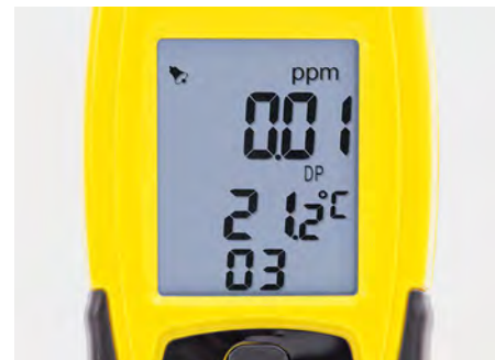
Podświetlany wyświetlacz LCD modelu OZ-ONE wskazuje jednocześnie dwie wartości pomiarowe. Są one czytelne także przy złym oświetleniu otoczenia.
