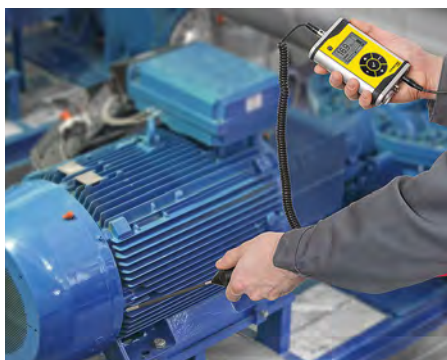
Czujnik drgań strukturalnych z końcówką ze stali szlachetnej jest optymalnie przystosowana do kontroli NDT zużycia łożysk wirujących elementów maszyn.
