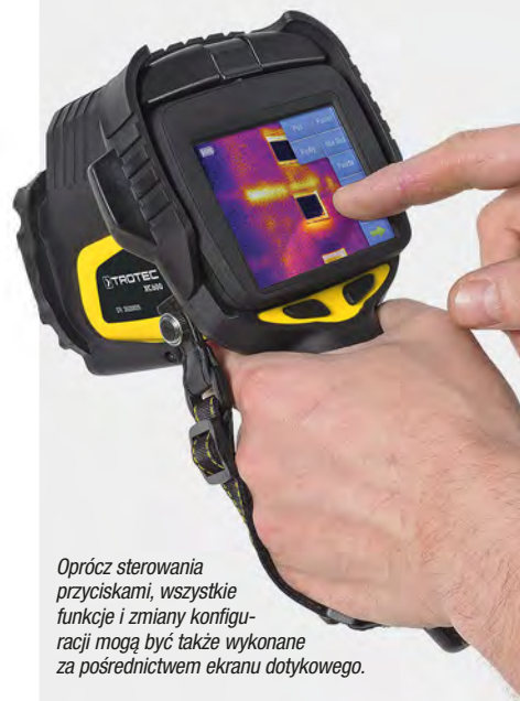
Modele XC300 i XC600 mogą być sterowane za pomocą przycisków lub ekranu dotykowego. Podświetlana klawiatura ułatwia obsługę także w warunkach ograniczonego oświetlenia.
