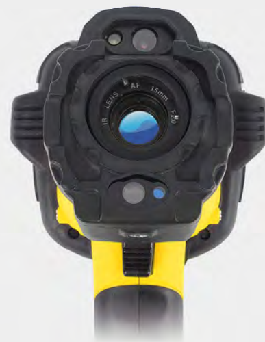
Składające się z dwóch modułów, wytrzymałe kamery serii XC są odporne na uderzenia i posiadają stopień ochrony IP54. W przedniej części, obok standardowego obiektywu (24° x 18°) znajduje się także kamera obrazów rzeczywistych, lampa fotograficzna, wskaźnik laserowy oraz dodatkowy laser do pomiaru odległości.
