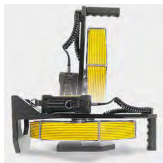
Bęben kabla wsuwanego jest tak skonstruowany, że możliwe jest jego zastosowanie w pozycji stojącej oraz leżącej.
