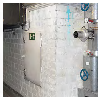
W obecności światła UV środek Uranin Blue wyróżnia się bardzo wysokim kontrastem i, dzięki charakterystyce kapilarnej jest idealnie przystosowany do lokalizacji wycieków przy przenikaniu mineralnych materiałów budowlanych.
