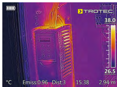
W celu uzyskania lepszej orientacji, włączana w trakcie pomiaru funkcja DuoVision Plus uwypukla istotne detale takie jak opisy i zarysy obiektów.
