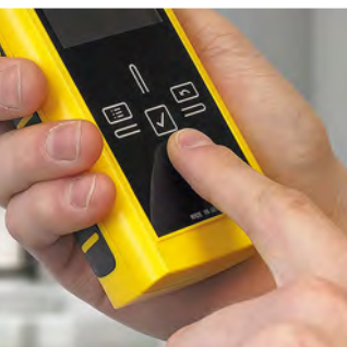
Pojemnościowy, dotykowy ekran modeli T210 oraz T260 jest wyposażony w przezroczystą warstwę odporną na zarysowania szkła Blanview.
