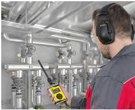
Per Richtschallsonde lassen sich Leckagen an nicht verdeckt liegenden Leitungen punktgenau lokalisieren.
