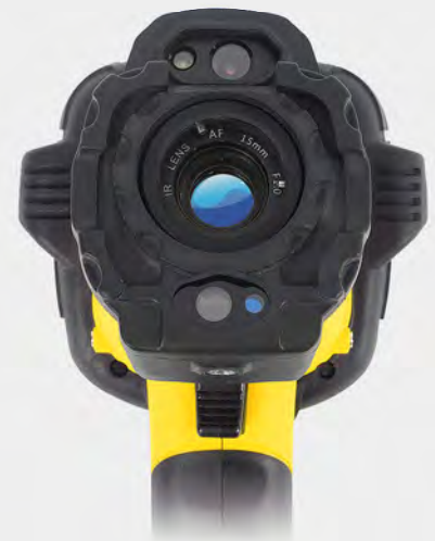
Die robusten XC-Kameras sind in stoßgeschützter Zweikomponentenbauweise mit Schutzart IP54 gefertigt und beherbergen frontseitig neben dem Standardobjektiv (24° x 18°) eine Realbildkamera, Fotoleuchte, einen Laserpointer sowie einen Zusatzlaser zur Entfernungsmessung.
