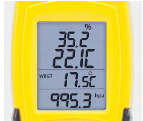
Das hintergrundbeleuchtete LCD des TC100 zeigt gleichzeitig vier Messgrößen an, die sich auch in schlecht beleuchteten Umgebungen gut ablesen lassen.
