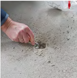
Schritt 1: Die Probe wird wie gewohnt über den gesamten Querschnitt des Estrichs entnommen und in einen Beutel gefüllt.
