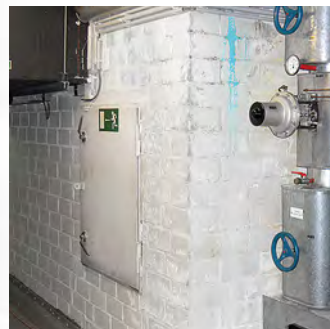
Unter UV-Licht ist Uranin Blue äußerst leuchtstark und eignet sich aufgrund seiner guten Kapillargängigkeit ideal für Leckortungen mit Durchdringung mineralischer Baustoffe.
