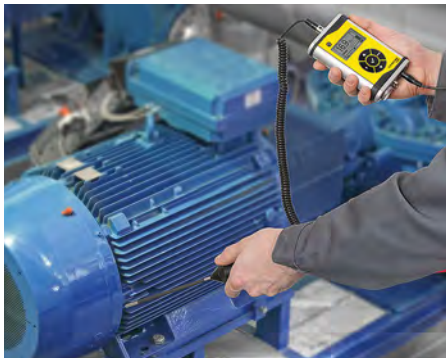
Die Körperschallsonde mit Edelstahlspitze eignet sich optimal für NDT-Prüfungen wie Lagerverschleißkontrollen an rotierenden Maschinenbauteilen.
