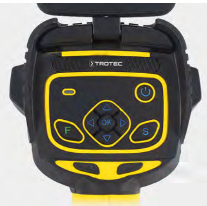
XC300 und XC600 können flexibel über Tasten oder Touchscreen gesteuert werden und ihre beleuchtete Tastatur erleichtert die Bedienung auch in dunklen Arbeitsumgebungen.
