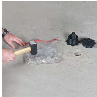
Schritt 2: Zerkleinerung des Probenmaterials, sodass das gesamte Prüfgerät eine Körnung nicht größer als 8 mm hat.
