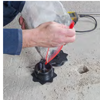
Schritt 3: Befüllung der Messkammer mit der Materialprobe.
