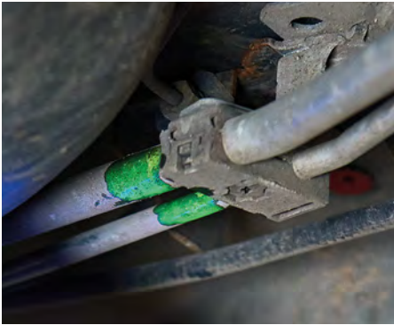
Leckage an der Kältemittelleitung einer Kfz-Klimaanlage unter UV-Licht mittels Kontrastmittel.
