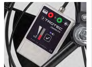
Bluetooth-Sender mit Anschlussmöglichkeit eines Frequenzgenerators und integrierter Geräuschpegelanzeige zur unterstützenden Orientierung während der Messung.
