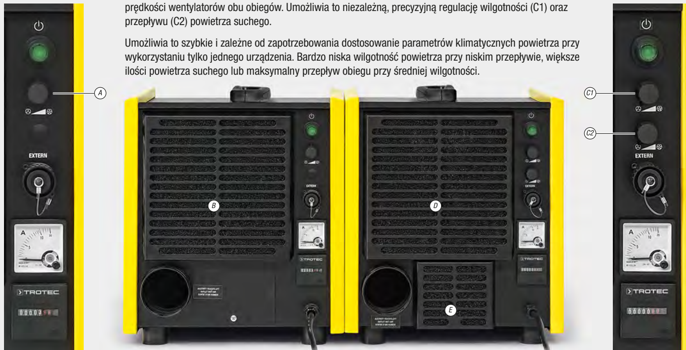
Bezpośrednie porównanie modeli: Po lewej stronie przedstawiony został model TTR 400 ze sterowaniem ilości powietrza Monoventic (A) oraz połączonym wlotem obu strumieni powietrza (B). Po prawej stronie widoczny jest model TTR 400 D ze sterowaniem Duoventic (C1, C2) i oddzielnymi wlotami powietrza suchego (D) oraz powietrza regeneracyjnego (E).
