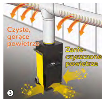
Wylot powietrza DualDecon w wyposażeniu standardowym ① zapewnia wolne od przeciągów rozprowadzanie ciepłego powietrza w strefie 360° całego pomieszczenia. Dostępna opcjonalnie osłona przyłącza węża umożliwia zastosowanie do centralnego ogrzewania pomieszczeń, np. w przypadku warsztatów lub magazynów ② lub podłączenie modelu TAC XT do istniejących systemów wentylacyjnych ③.
