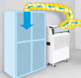
Systematyczny, przykładowy schemat zastosowania funkcji Spotcooling w modelu PT 6500 S.
