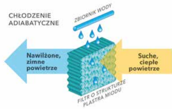
Chłodzenie adiabatyczne z zastosowaniem klimatyzatorów mobilnych
